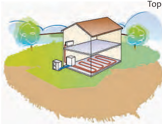
ZRAK - VODA toplotne pumpe koriste vanjski zrak kao izvor
